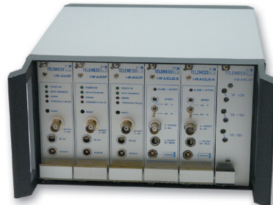
I-W-A / EN 4 - Aufnahmeeinheit für fünf Messkanäle mit Stromversorgung
